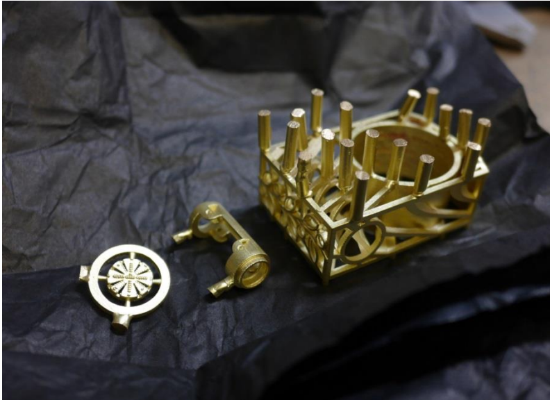
Die Gussteile vor der Versäuberung
